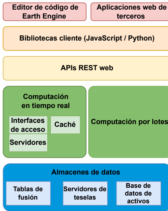
Figura 2.3: Arquitectura general de Google Earth Engine para análisis satelital en la nube. Elaboración propia basada en Gomes et al. (2020)[2].
